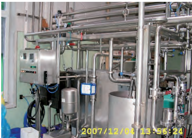
Abb. 11.1: Anlage zur Pasteurisierung von Fruchtsaft (Quelle LÜVA Freiberg)
