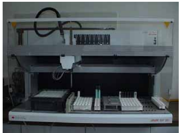
Abb. 7.1: Pipettierautomat beim Herstellen von Milchpools aus Einzelmilchproben
