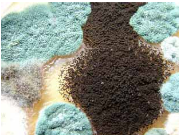
Abb. 9.5: Nachweis von Schimmelpilzen aus einer Raumluftprobe
